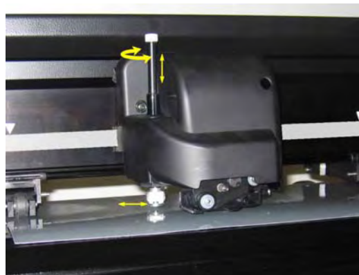
ABB 1-32 EINFÜHREN DES TANGENTIALEN MESSERHALTERS
