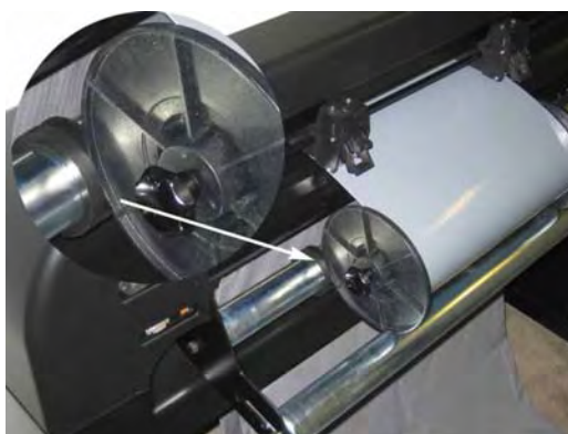
ABB 1-20 POSITIONIEREN DES WERBETRÄGER SPURKRANZES AM CUTTER
