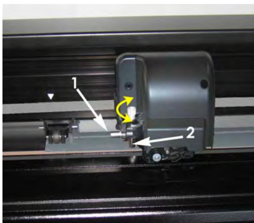
ABB 1-24 ENTFERNEN DES SCHLEPPMESSERHALTERS VON DER KLEMMME
