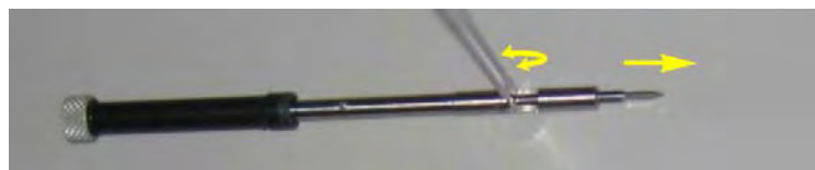
ABB 1-30 ENTFERNEN DES MESSERS VOM TANGENTIALEN MESSERHALTER
