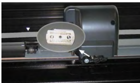
ABB 1-35 RASIERKLINGE FÜR AUTOMATISCHE TRENUNG DES WERBETRÄGERS
